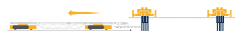
Bramownice w górę, wózek z kratownicą odjeżdża / Gantries are raised, the trolley with the truss departs
